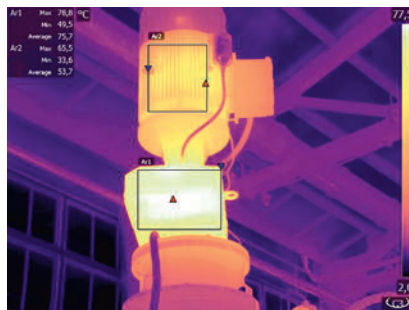
Рис. 4. Недостаточное охлаждение редуктора, необходимо проверить смазку
